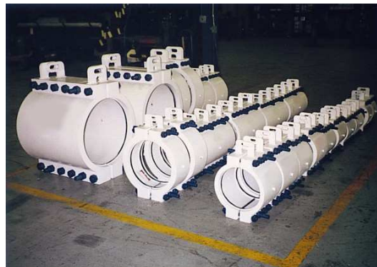
Verschiedene geteilte mechanische Reparatur-Kupplungen, geprüft, lackiert und bereit zum Versand
