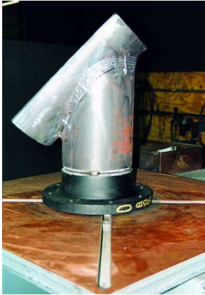
8" (DN 200) maßgeschneidertes Verbindungsstück für Hot-Tap-Verfahren unter einem Winkel von 45°
