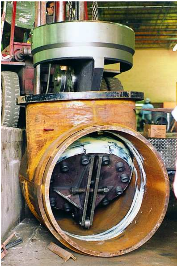
46" (DN 1150) Hochdruck-Absperrkopf wird ausführlich getestet um den Betriebsparametern gerecht werden zu können
